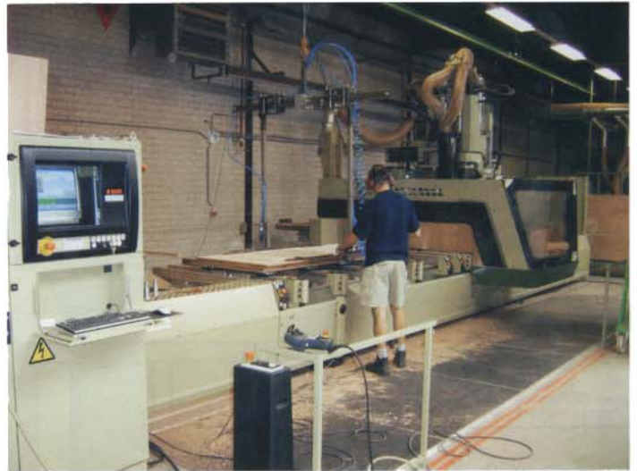
Vielseitiger Allrounder: SCM Record 240 Prisma für Türen und Rundteile
