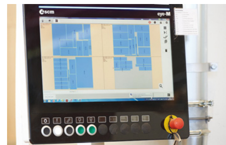
CAD Line optimiert die Schnittpläne und lässt kompakte Reststücke zurück
