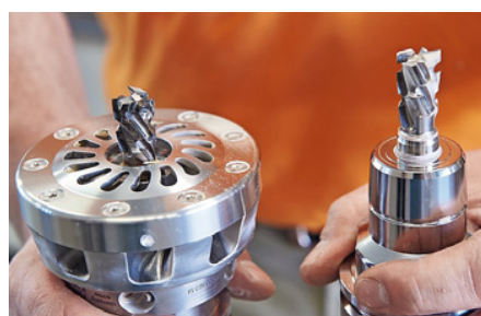
Reichenberger arbeitet mit dem Schaftfräser Diamax von Leuco und einer Absaugturbine
